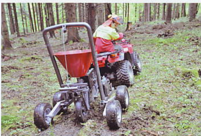
Quadsaat: Mit Bogieachsen für den Einsatz in schwerem Gelände.
